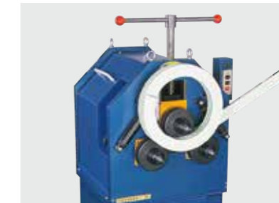
フラットバー縦曲げ
